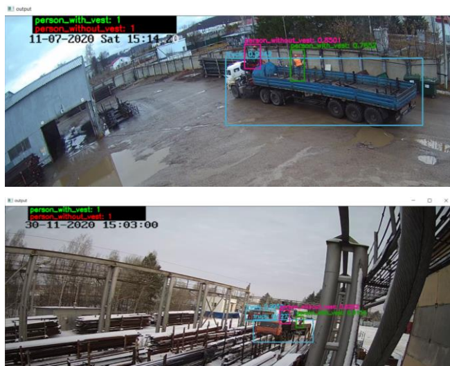
Рис. 2. Результат работы сверточной нейронной сети YOLOv3 обученной на производственном наборе данных
