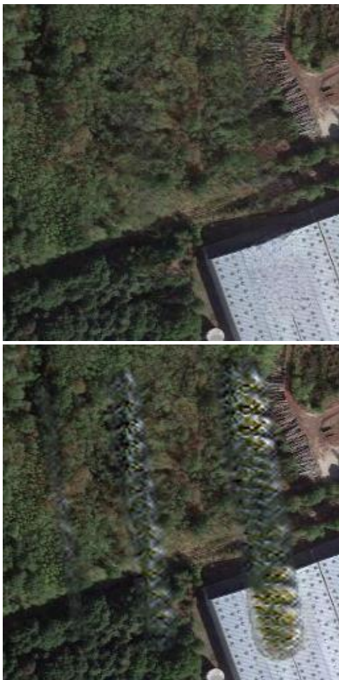
Рис. 2. Сравнение нейросетевых алгоритмов доопределения малоинформативных областей изображений для сжатия: результаты доопределения посредством CNN и GAN
