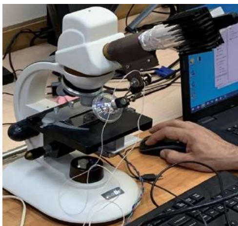
Рис. 1. Внешний вид микроскопа с гиперспектральной приставкой
