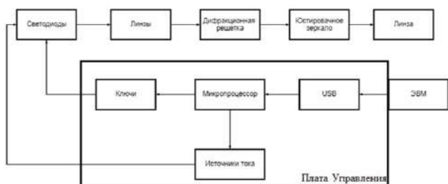
Рис. 2. Структурная схема макета источника света с программно-управляемым спектром
