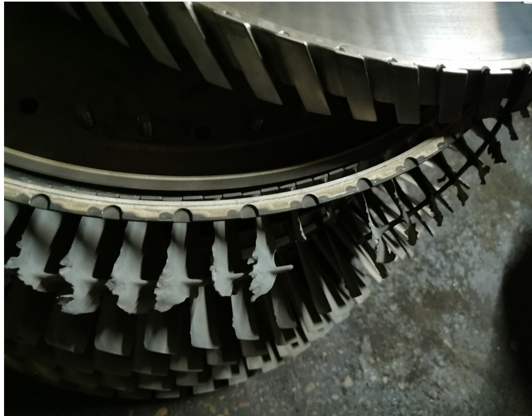
Рис. 1. Не прошедшее испытания рабочее колесо
