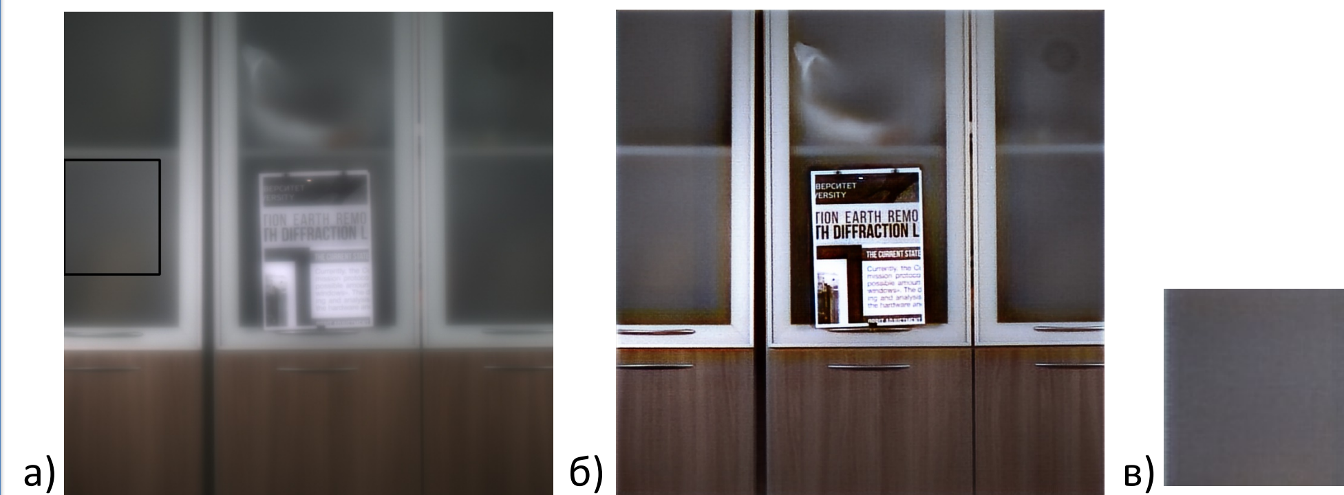
Рис. 3. Изображение реальной сцены, используемое в процессе обучения сети, где фрагмент размера 200x240 пикселей, выделенный черной ограничивающей рамкой, используется при оценке FEL (а), обработанное изображение реальной сцены (б, в)
